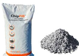
Consommation ChipFill™ : Sac de 12 kg = 0,4 m<sup>2</sup> couverts pour une épaisseur de 15 mm appliqué, soit 40 mètres de joints largeur moyenne 10 mm et profondeur 15 mm.
